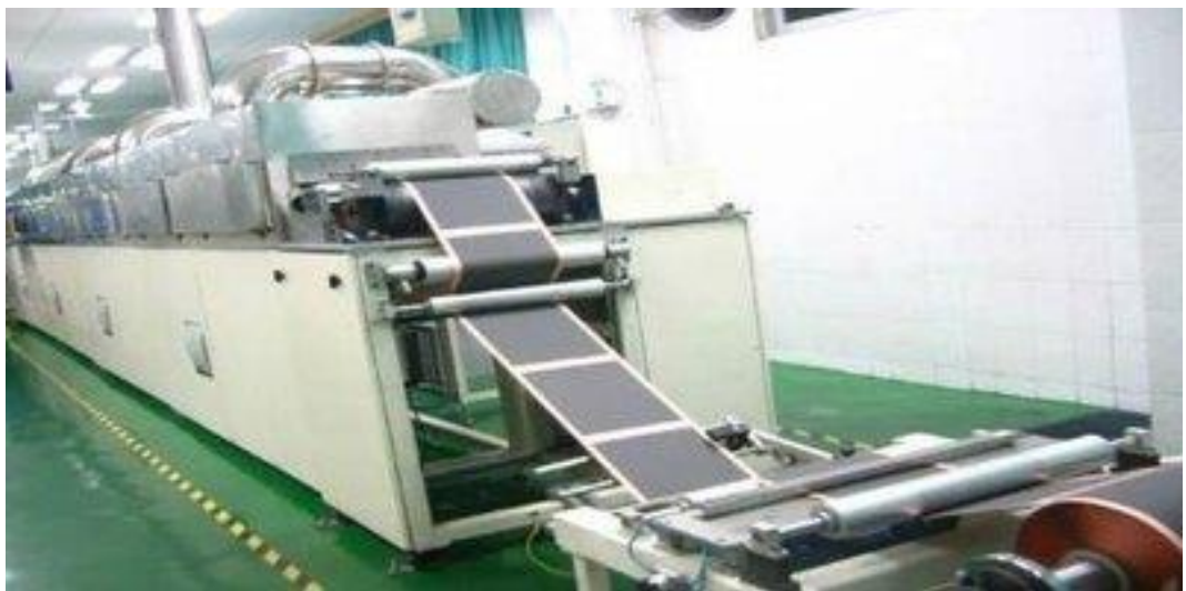
图 2：涂布机工作示意图
